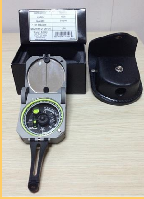
Arazide yapısal ve çizgisel ölçümlerde kullanılan jeolog pusulası
