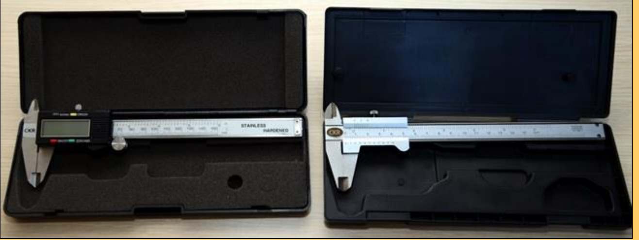
Düzeltilen karotların boy ve çaplarının hassas olarak ölçülmesi işleminde kullanılan kumpaslar
