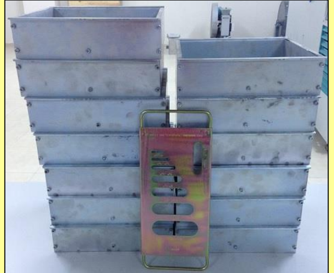
Agregaların yassılık indeksi ölçülmesinde kullanılan elek seti
