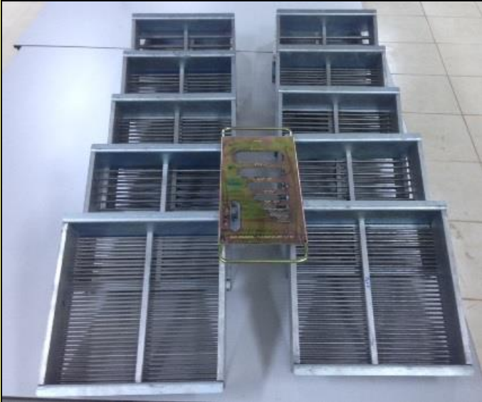
Agregaların yassılık indeksi ölçülmesinde kullanılan elek seti
