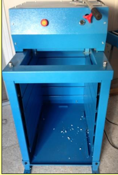
Agregaların yassılık indeksinin ölçülmesinde kullanılan otomatik elek sallama cihazı
